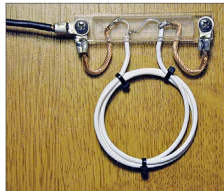
Bild 3: Fertig eingesetzter und verlöteter Sperrkreis
