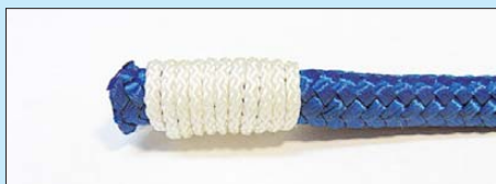
Bild 3: Fertiger Takling mit beschnittenen, nicht mehr sichtbaren Seil-Enden
