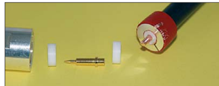
Bild 7: H2000 mit gekürztem Innenleiter und eingeschobenem Schaftkegel
