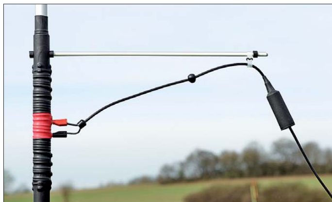
Ein kurzes Einspeisekabel mit Steckern stellt die Verbindung zwischen Antenne und Antennenkabel her.
