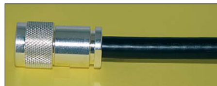
Bild 10: Die Mutter sollte man nicht bis zum Anschlag festdrehen.
