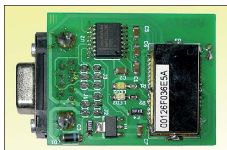
Trotz der SMD-Bauteile ist die Platine des AS519 rasch bestückt. Foto: AATiS
