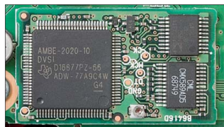
Bild 18: Sehr klein ist das optionale Modul UT-121 für den DV-Betrieb und die DV-GPS-Funktionen, das hinter der Fronteinheit aufzustecken ist.
