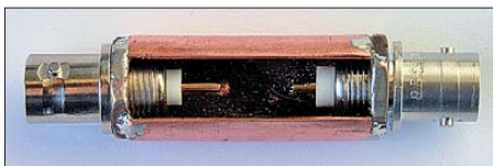
Bild 9: Das über die gesamte Länge aufgeschlitzte Rohr bietet gute Sicht auf die Bauelemente im Innern und relativ bequeme Einbaumöglichkeiten.
