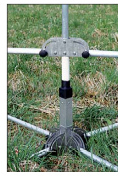
Das Element für die untere Endkapazität wird in das isolierende Fiberglasrohr gesteckt.
