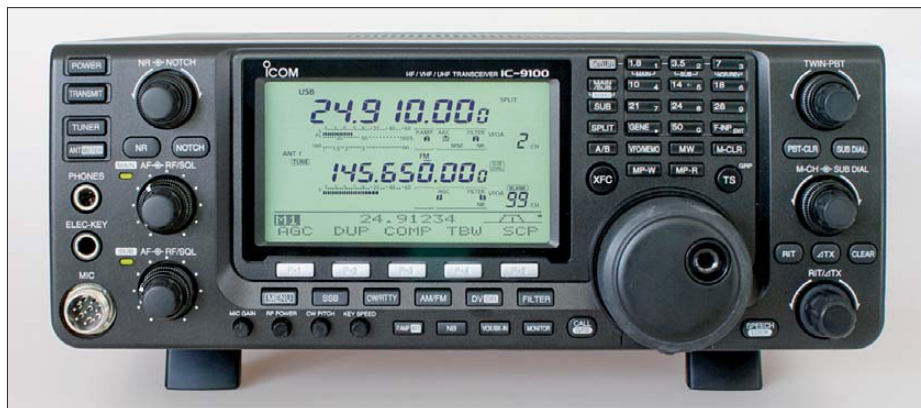
Bild 1: Frontansicht des IC-9100; die beiden Frequenzanzeigen für den Haupt- und den Subempfänger sowie die Punktmatrix für diverse Anzeigen (unten) dominieren das Display.
