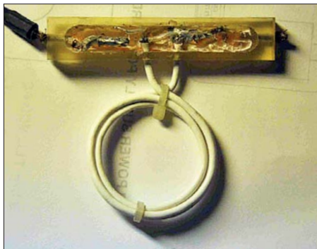
Bild 1: Defekter Sperrkreis mit bereits freigelegtem „Innenleben“
