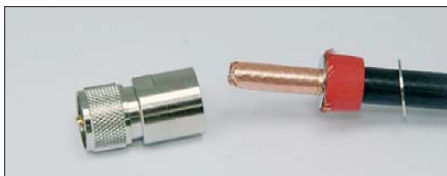
Bild 3: Nach dem Kürzen des Abschirmgeflechts
