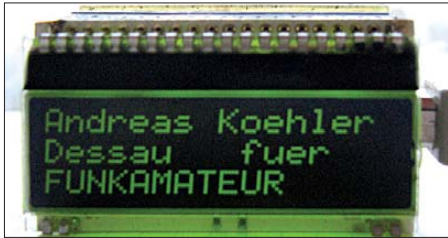
Bild 1: Die Leiterplatte mit dem USB-Schaltkreis besitzt die gleiche Größe wie das aufgesteckte LC-Display. Foto: Köhler
