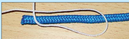
Bild 1: Die Fadenschlaufe ist beim Setzen des Taklings einzubinden. Fotos: DL2DUA
