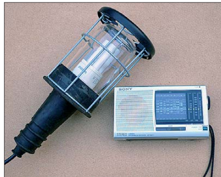
Bild 2: „Ausrüstung“ zur Kabelortung; links befindet sich die in einer Gummi-Handleuchte eingeschraubte und als Signalgenerator dienende Energiesparlampe, rechts das kleine MW/LW-Radio. Fotos: DG9WF
