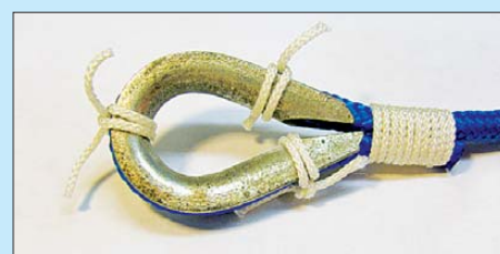
Bild 15: Die Kausche ist mit einigen Hilfsseilen beim Setzen des Taklings festzuhalten.
