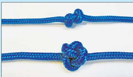
Bild 6: Vergleich zwischen Achtknoten (oben) und Austernfischerstopper (unten)
