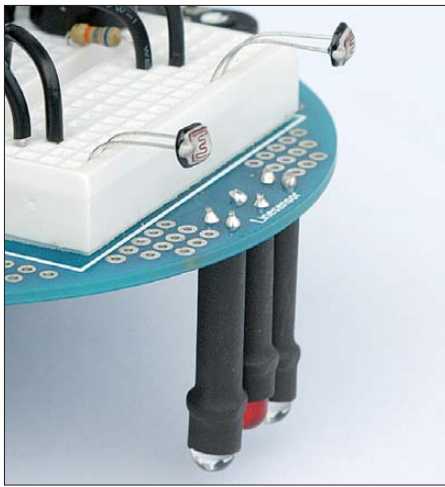
Bild 3: Der Liniensensor im Detail; im Steckbrett sind zwei lichtempfindliche Widerstände zu sehen. Fotos: DL1DMW
