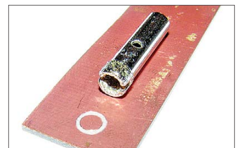
Bild 11: 6-mm-Fliesenbohrer als Lötinselfräser
