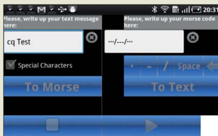
Morse Droid: Auf der linken Displayhälfte lässt sich Text eingeben und in Morsesignale umsetzen; rechts daneben liegen die Schaltflächen zur Decodierung.
