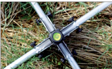
Eine abnehmbare Wasserwaage unterstützt die Ausrichtung des Stativs.
