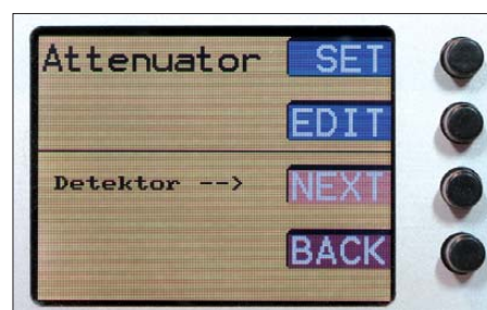
Bild 17: Über diesen Menüpunkt lässt sich ein zusätzlich zu berücksichtigender Dämpfungswert einstellen.
