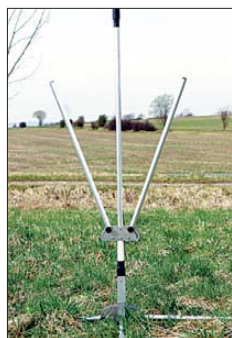
Durch die Änderung des Winkels der beiden unteren Ausleger ändert sich die Resonanzfrequenz.
