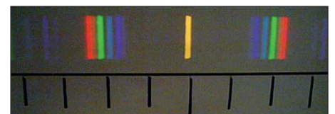
Bild 4: Markante Linien im Gitterspektrum der 21-W-Energiesparlampe
