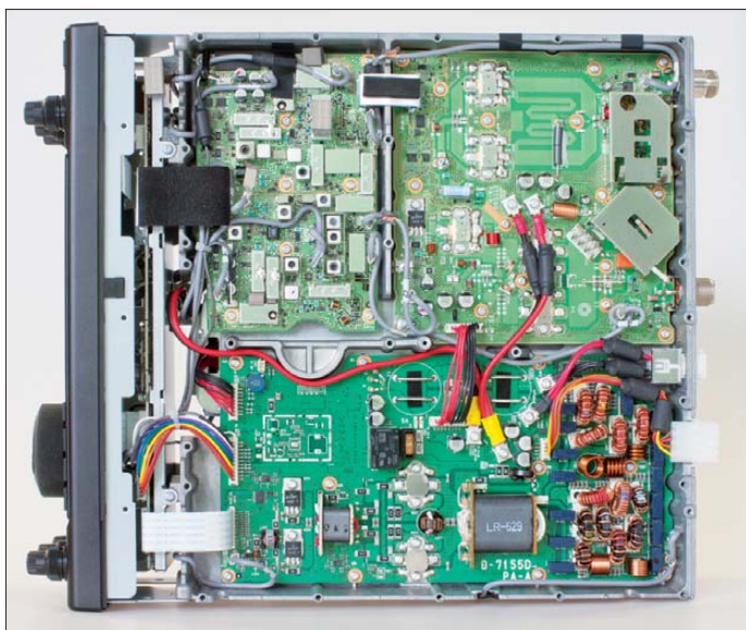
Bild 14: Blick von unten in das geöffnete Gerät; unten im Bild der Platz für die optionale 23-cm-Einheit UX-9100, in der Bildmitte der geregelte Lüfter, links daneben die Steckplätze für die Roofing-Filter, oben rechts der Antennentuner
