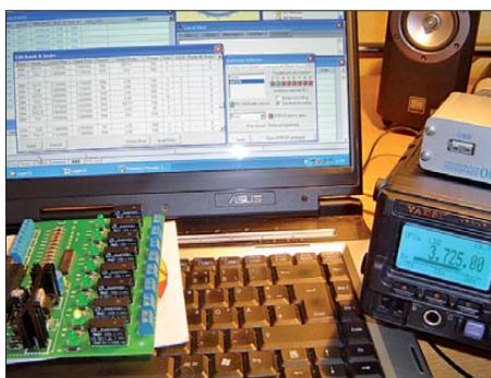
Bild 4: Der FT-897 ist auf eine Frequenz im 80-m-Band eingestellt, auf dem Bildschirm des Laptops erkennt man die Einträge für das 80-m-Band (Antenne 2) und auf der Platine leuchtet folgerichtig LED2.
