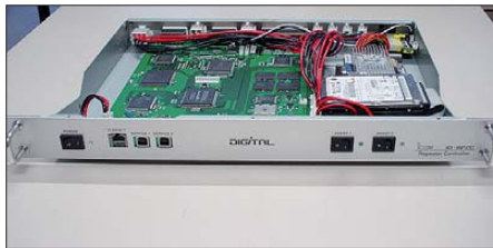
EPIA-PX1000-Board, eingebaut in einem RP2C mit einer 2,5"-HDD
