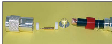
Bild 6: Diesmal reicht es, den Mantel auf 6 mm zu entfernen.
