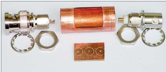
Bild 7: Mittels Metallsäge und Feile bearbeitetes Rundgehäuse mit BNC-Stecker und -Buchse sowie einer in Lötinseltechnik hergestellten Platine
