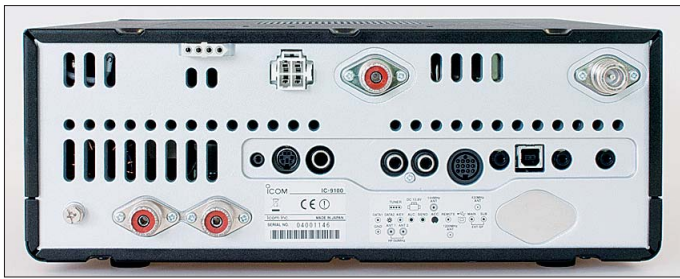
Bild 2: Rückansicht des IC-9100; die beiden Antennenbuchsen für KW/6 m können den Bändern beliebig zugeordnet werden. Statt die Buchsen einzeln zu beschriften, gibt es nur ein kleines Übersichtsetikett.
