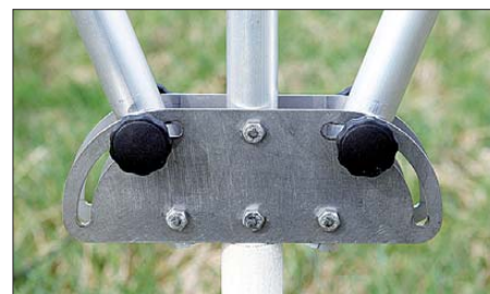
Knebelschrauben halten die Ausleger der Endkapazitäten in ihrem Stellwinkel.
