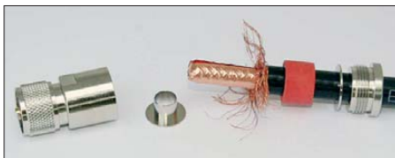
Bild 1: Nach dem Entfernen des Mantels muss man die Schirmung entflechten.
