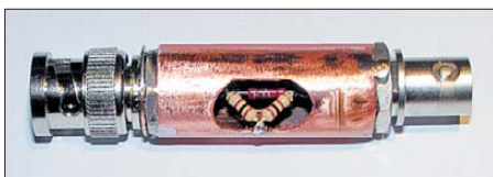
Bild 8: Kupferrohrgehäuse mit einem Dämpfungsglied und ovalem Sichtfenster
