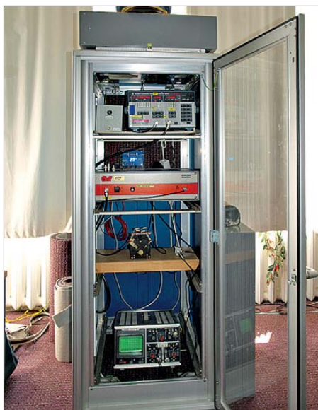
Das Sendegestell von welle370 im Betrieb. Oben links NF-Filter, daneben Steuersender, darunter Linearverstärker, darunter Oberwellenfilter, unten Kontrolloszilloskop
