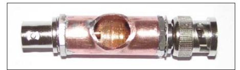
Bild 5: Fertiges Gehäuse aus einem T-Stück
